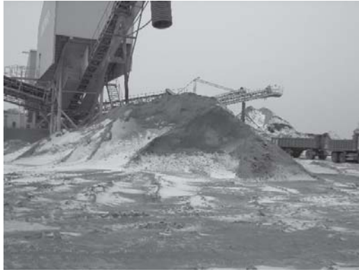
Røynebergsand (0-2 mm) i haug under steinknuseren ved pukkverket.
