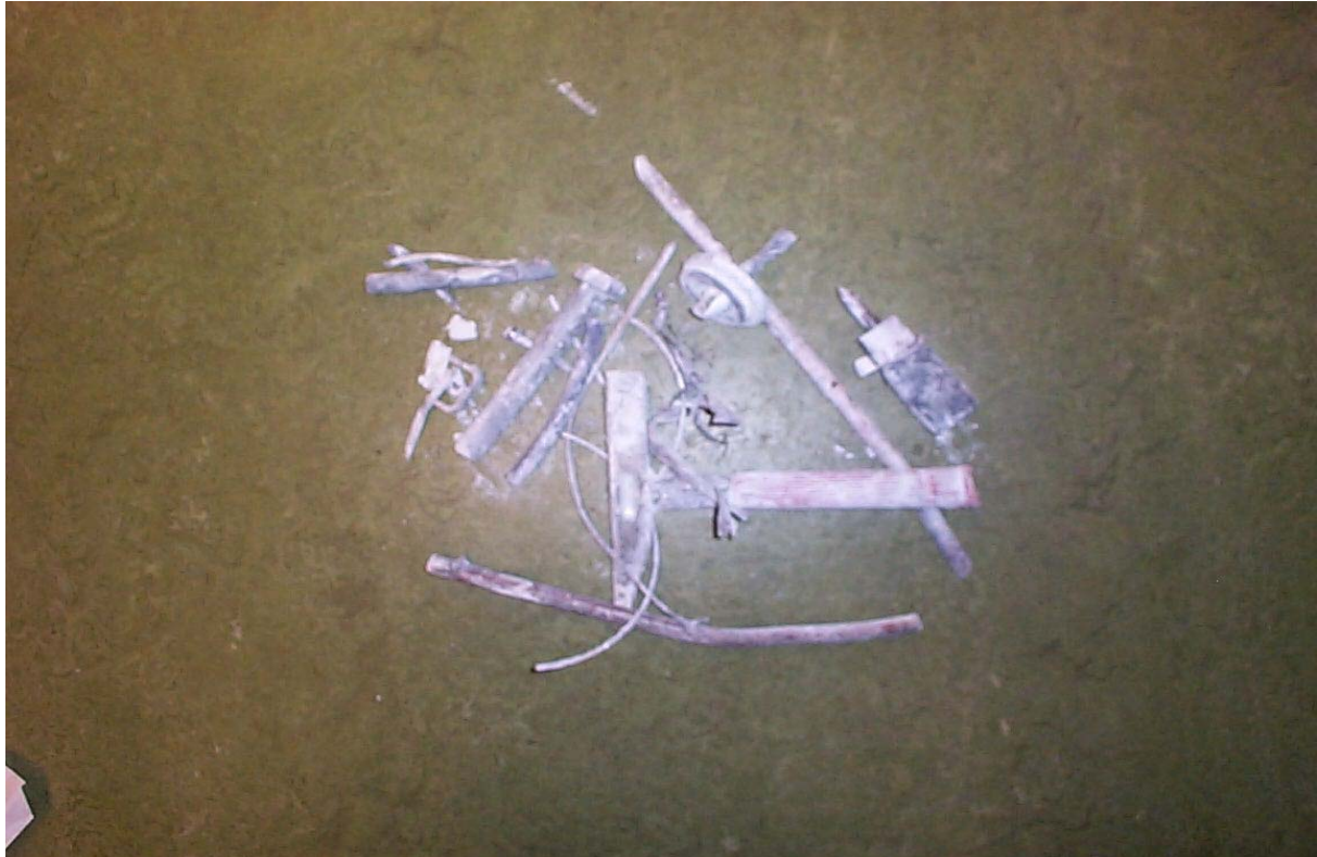
Fig. 3. Sabotasjesak ved produksjon av Visnes filterkalk kat. 3 – avfall (jernstenger, hammar, limtuber m.m.) funne ved innblåsing på filter til kalksilo ved doseringsanlegg på Tuland i Fjaler, Sunnfjord (foto: Fjaler kommune).
