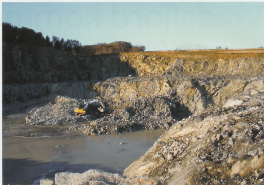
Dagbrot i Røyneberg på Jæren for framstilling av kaliumhaldig 0-2 mm sand.
